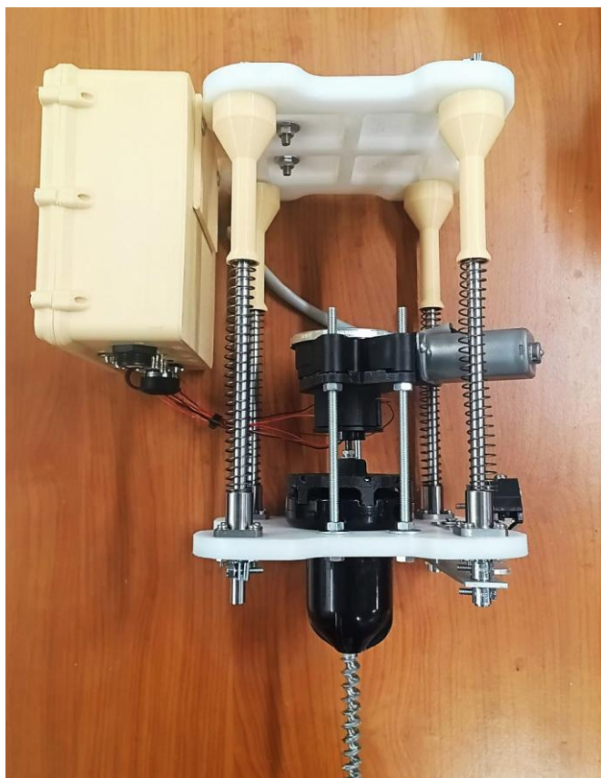
Рисунок 2.23 – Сейсмический модуль интегрированный с системой установки
