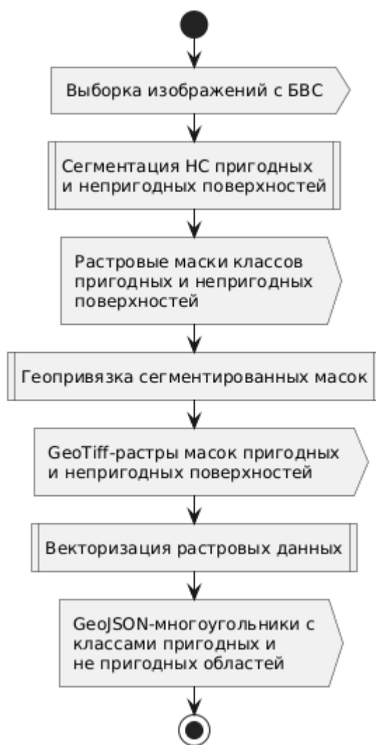
Рисунок 1.8 – Процесс работы модуля семантической сегментации на основе глубокой нейронной сети
