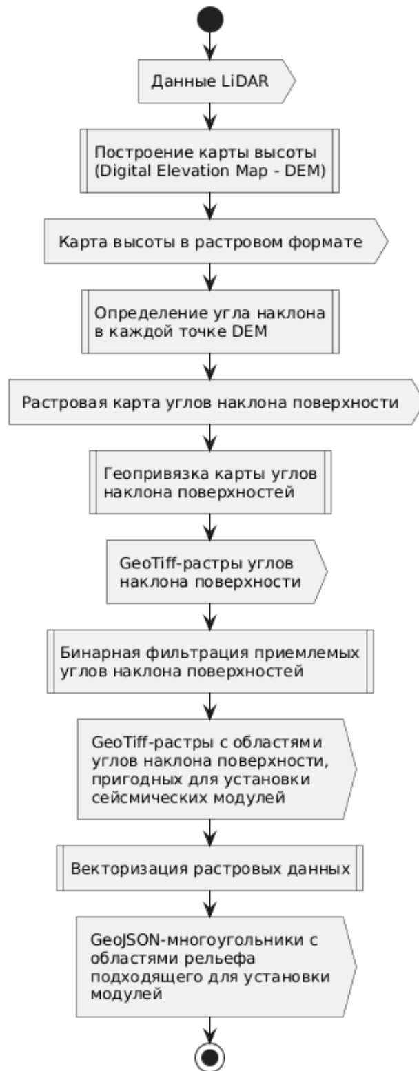
Рисунок 9 – Процесс вычисления карты углов наклона поверхности
