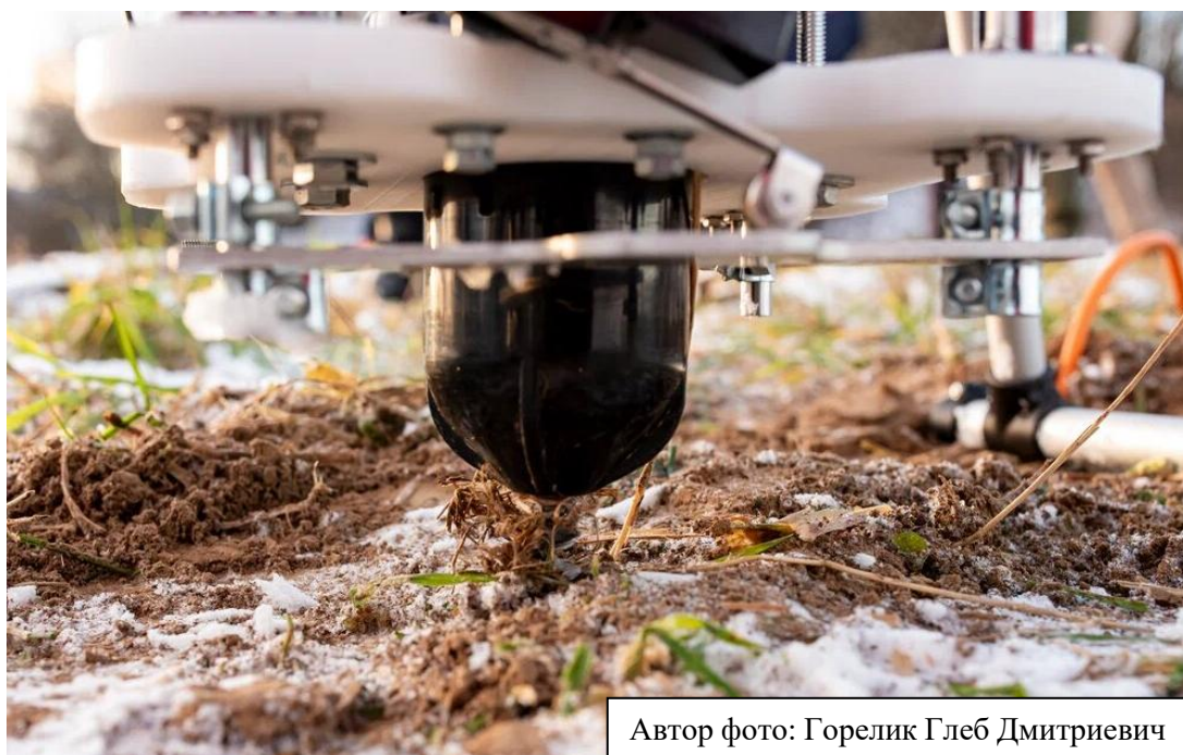
Рисунок 2.34 – Вкрученный в грунт сейсмический датчик
