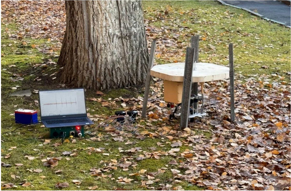
Рисунок 2.28 – Эксперимент по сравнению контакта с грунтом при стандартной установке датчика и установке с помощью разработанного механизма заглубления
